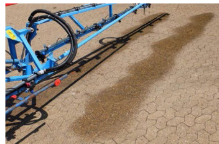
Feito para garantir que a distribuição da pulverização seja igual em ambos os lados da barra quando os bicos forem instalados em direções alternadas
