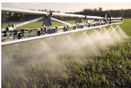
Instale voltado para direções alternadas ao longo da barra a fim de fornecer cobertura em ambos os lados do alvo
