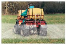
Os bicos Boom X Tender são ideais para pulverização sem barra ou como a última ponta em uma barra de pulverização.
